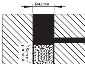
2. Passe os cabos de rede elétrica pela abertura lateral do alojamento e chumbe-o no solo, nivelando com a superfície do piso.
