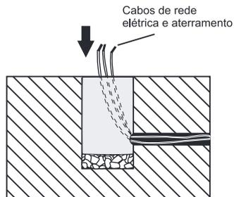
3. Faça a instalação elétrica adequadamente, isolando bem as conexões.
